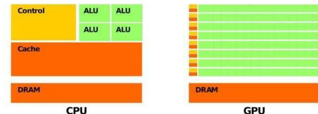
图表6 CPU 与 GPU 架构对比
